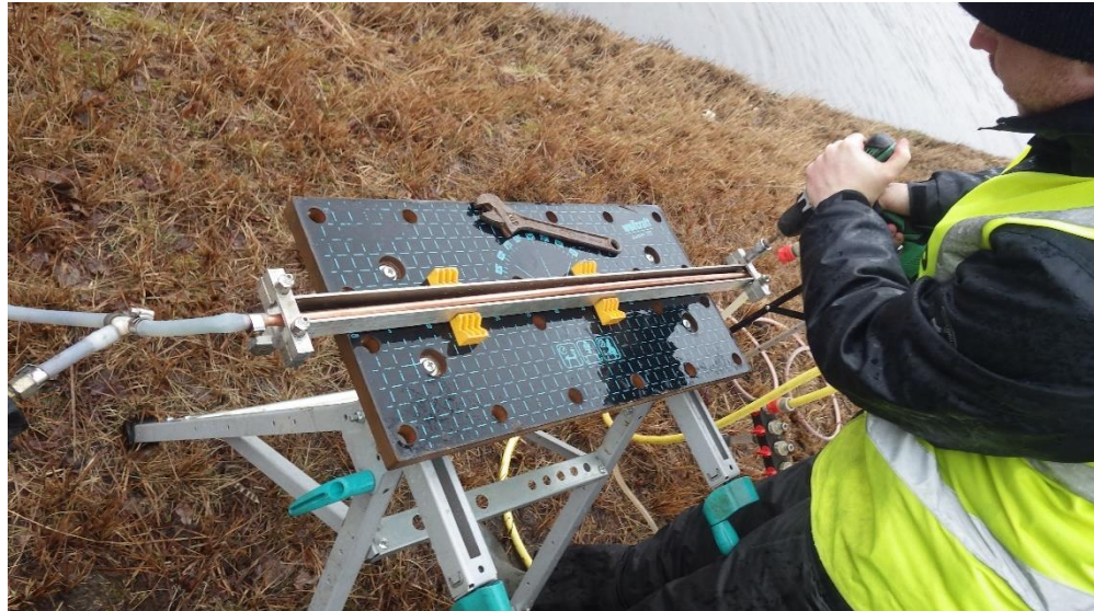
Figuur 2.1 Het afklemmen van de koperen buizen waarin het grondwatermonster voor de bepaling van ^3\text{He} onder druk is opgeslagen.
