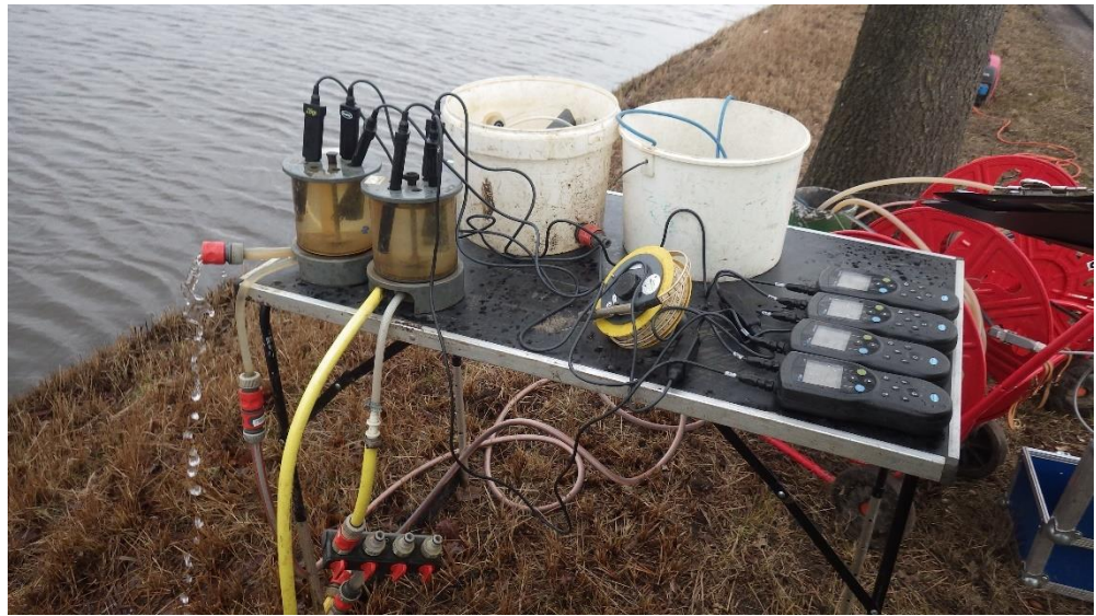
Figuur 2.2 Het meten van pH, zuurstof, EGV en temperatuur (in een doorstroomcel) en TDG (in-situ) tijdens afpompen en bemonstering van een grondwaterfilter.
