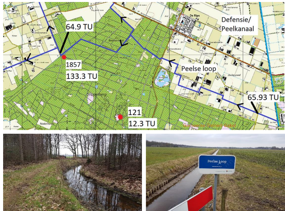
Figuur 3.6 Boven: mogelijke infiltratie van Maaswater uit het Peelkanaal vanuit de Peelse Loop bij put 1857. Linksonder: Peelse Loop bij put 1857. Rechtsonder: Peelse Loop ter hoogte van de Landmeter van Beurdenweg
